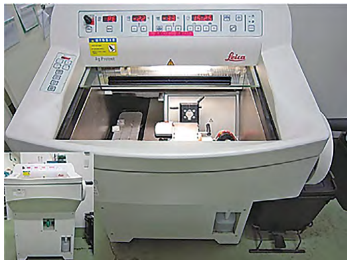
図1. 主流はハンドルを回す回転式ミクロトームを冷凍庫の中に組み込んだような構造になっており庫内は試料の状態に合わせて -15^{\circ}\text{C} \sim -25^{\circ}\text{C} くらいの温度が適温。
