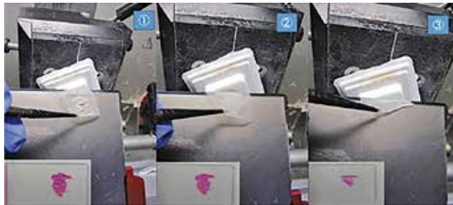
図5. ①過冷却②適温③冷却不足
